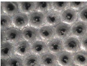
Abbildung 5: Im LBM-Prozess hergestellte Wärmetauscherstrukturen mit Wandstärke/ Kanaldurchmesser 300 µm; Untersuchung der Oberflächenbeschaffenheit im Lichtmikroskop. Vor der Wärmebehandlung (oben). Nach der Wärmebehandlung (unten)
