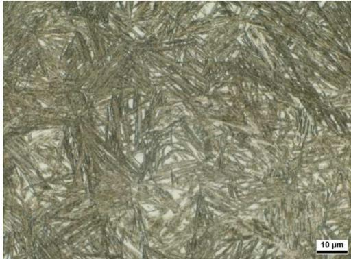
**Bild 4: Gefüge nach dem Bainitisieren (18CrNiMo7-6 J8 (+1,0 Masse-% Si); Zeit-Temperatur-Folge: 3 K/min 950 °C 5 min / 240 °C 10 h / RT; Schlißflage: Längsschliff; Ätzung: 50 s, 3% alk. HNO<sub>3</sub>)**
