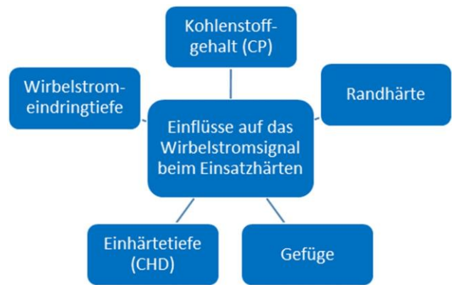
Abbildung 6: Zusammenhänge zwischen der Charakteristik der Randzone beim Einsatzhärten und den resultierenden Wirbelstromsignalen.
