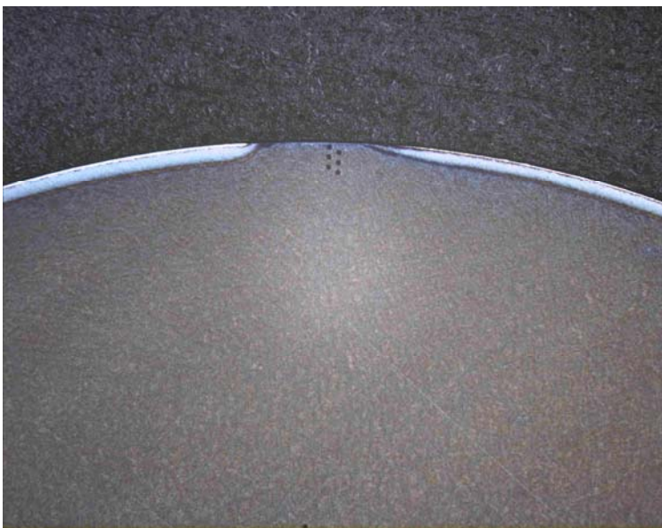
Bild 1 Störung im Aufbau der Nitrierschicht durch Passivierung
